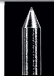
200+ kaynak sonrası Toryum içermeyen HFT Multistrike Tungsten elektrot
