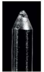
20 kaynak sonrası %2 Toryum içeren sıradan Tungsten elektrot
